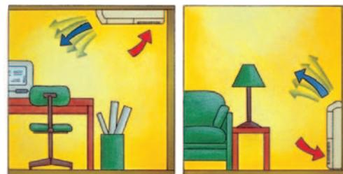
Alle Installationsarten sind ohne Änderung des Gerätes möglich: am raumsparendsten an der Decke, mit Wandaufhängung oder einfach auf dem Boden, unter einem Fenster aufgestellt.
